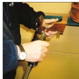
Även en från början anatomisk kolv kan behöva justeras genom att t.ex. slipa bort mtrl.
